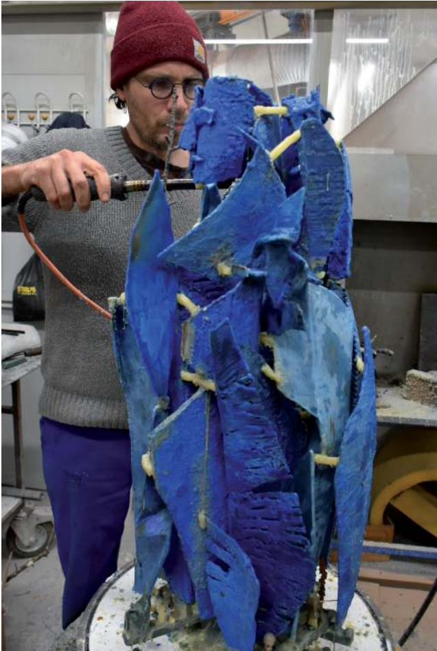
Travail de la cire et coulée en bronze à la Fonderie Barthélémy de Crest 2022
